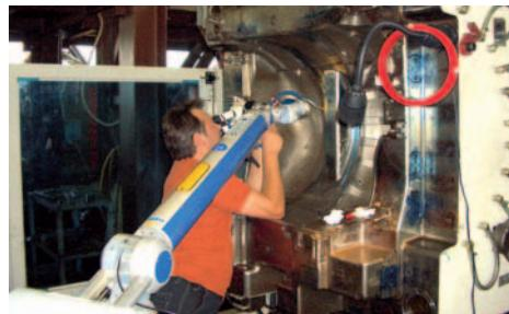
Saldatura mobile come riparazione direttamente in macchina su uno stampo ad iniezione.
