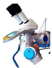
Contemporaneamente si può ruotare l'ottica del raggio laser a piacere di 360° in ogni direzione. L'illuminazione anulare a LED integrata serve per avere la migliore visualizzazione del campo di lavoro.
